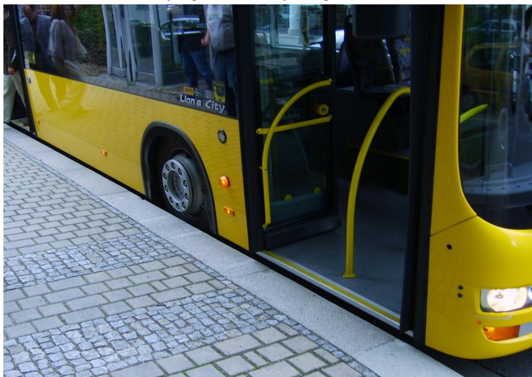
Rys. 3.1.2.7. Peron przystanku idealnie dopasowanego do taboru niskopodłogowego – Drezno (Niemcy) (źródło: opracowanie własne)
